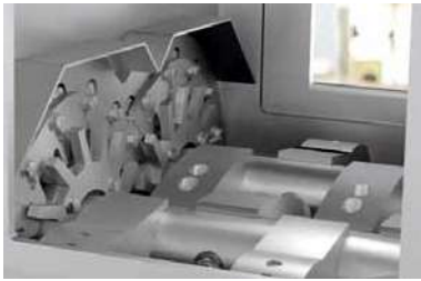
Fig. 6 Verdés Magnabloc's pre-compression zone (Figs.: Verdés)
