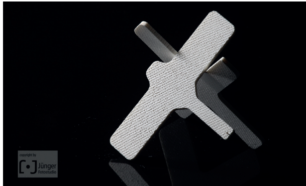
Bild 2 Aluminiumfaserlaminat zur Fertigung komplexer Bauteile, z. B. als Heißgasklappe auf eine Achse aus SiSiC laminiert
